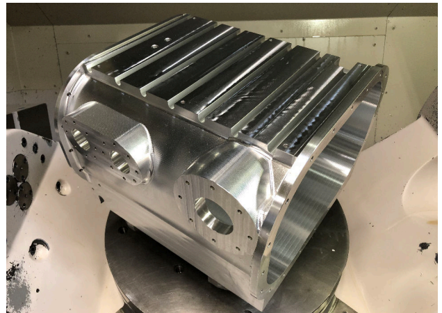
Bild: Mehrseiten-Bearbeitung eines Alu-Gehäuse auf einem 5-Achsen-Fräs-Drehzentrum von Okuma (MU-500VA-L)
