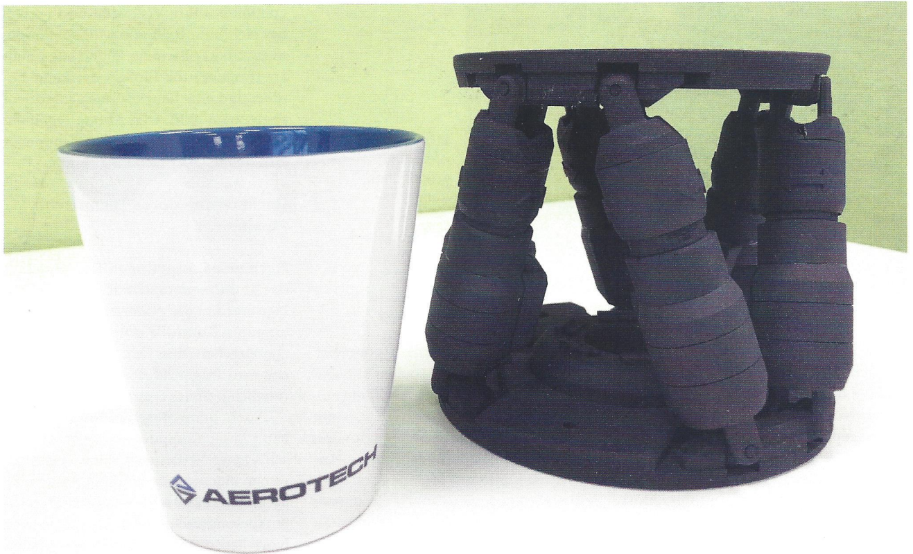
Der Hexapod HEX150 als 3-D-Modell. Der Größenvergleich mit der Kaffeetasse verdeutlicht den kompakten Aufbau.
