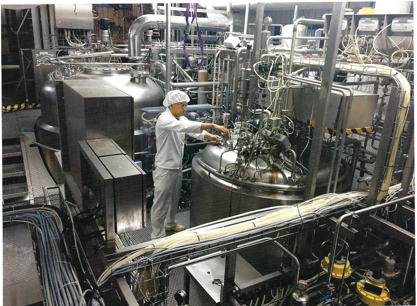
■ Abb. 1: Die Bakterienkulturen werden in einer Zentrifuge konzentriert, pelletiert und bei minus 55 Grad eingelagert und teilweise auch gefriergetrocknet. Danach werden die Bakterien bei minus 60 Grad zu unterschiedlichen Kulturen gemischt und abgefüllt, um später mit Milch zu Joghurt, Käse, Kefir und anderen Lebensmitteln verarbeitet zu werden.
