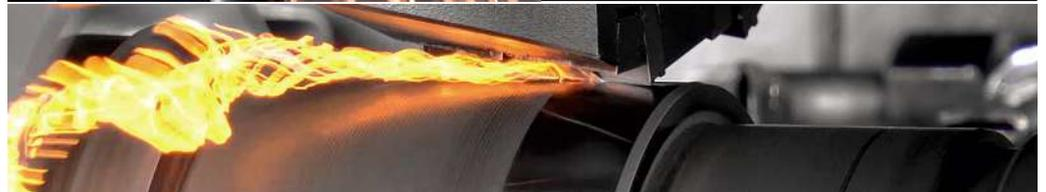
Das Innovationsspektrum von WEISSER umfasst beispielsweise das Pick-up-Verfahren, die Prozesstechnologien Hartdrehen, Rotationsdrehen und Unrunddrehen. Obige Abbildung zeigt die drall-arme Hartfeinbearbeitung mit dem patentierten WEISSER Rotationsdrehen 2.0 in Schleifqualität.
